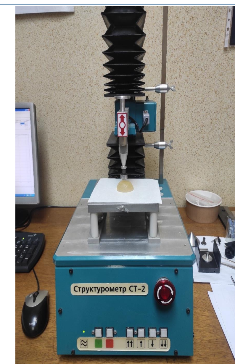
Рисунок 7 – Прибор для исследования структуры пищевых систем «Структурометр СТ-2»
